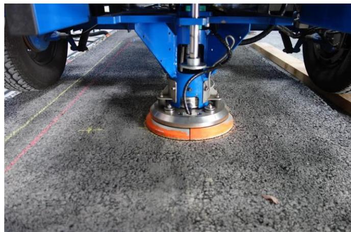
Figure 4. Essai de chargement avec le déflectomètre à masse tombante (FWD)
