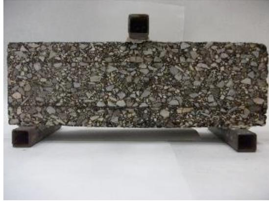
Figure 4. Eprouvette d'essai de fatigue. Flexion 3 points. Source : CIESM Intevia
